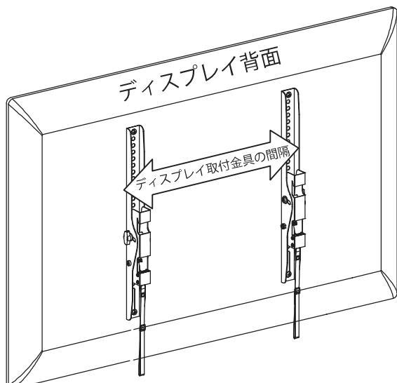
予めストッパーを「受け金具」へ設置する位置を確認してからディスプレイ取付金具の間隔より少し広めに取り付けてください。
