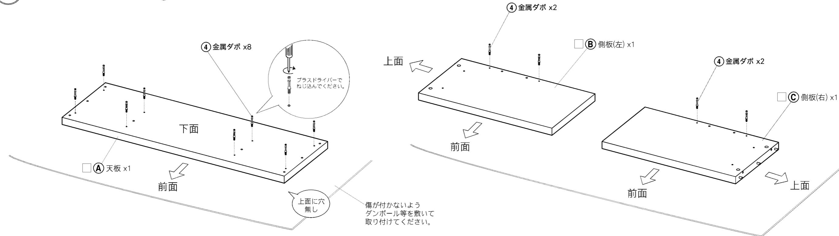
2 (B) 側板(左) (C) 側板(右)と (F) 後板の組み立て
