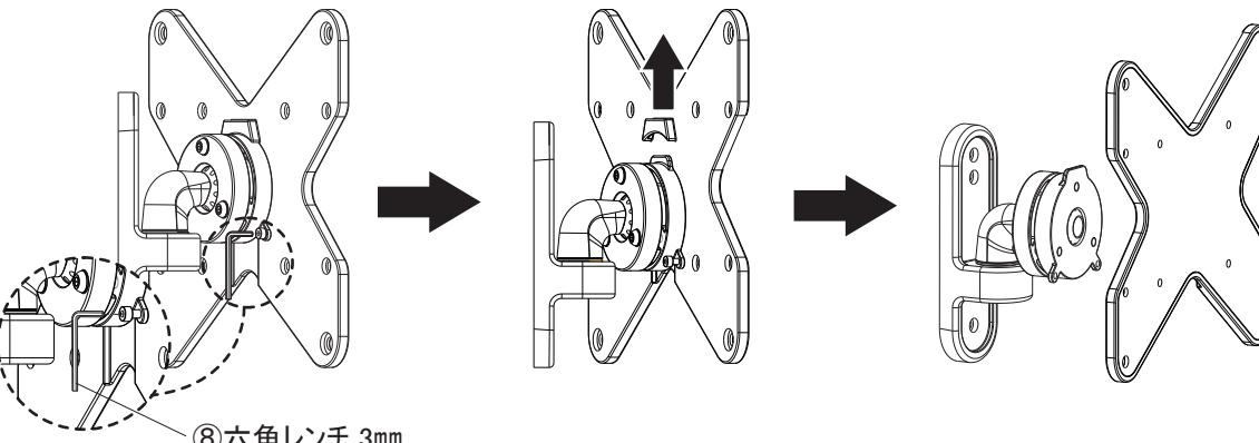
【手順2】金具本体を壁面に固定します。固定後に金具カバー(大)(小)を取付けます。
