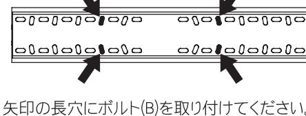
矢印の長穴にボルト(B)を取り付けてください。
