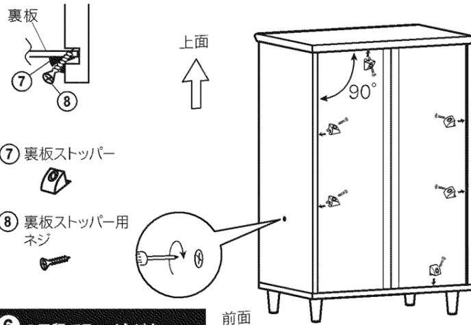
56の工程でラッパネジをゆるめた場合、締め直してください。
