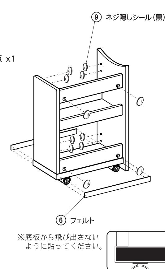
5 F 後板と D 底板(A) H 側板(B)の組み立て
