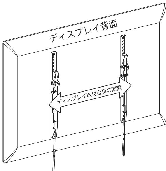
予めストッパーを「受け金具」へ設置する位置を確認してからディスプレイ取付金具の間隔より少し広めに取り付けてください。
