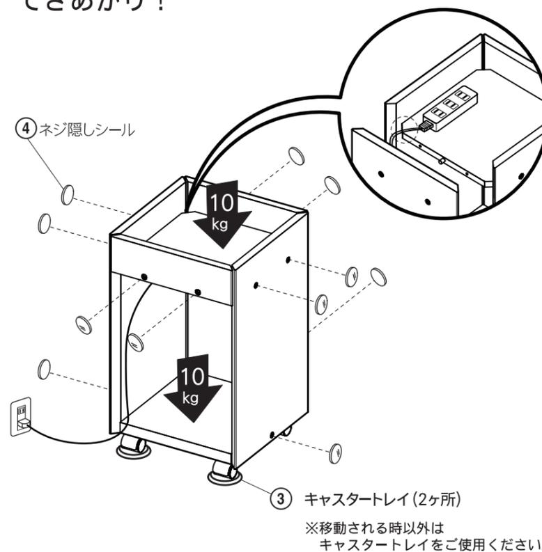
天板の角は、配線用に面取りされています。配線を通してからパネルを取り付けると収納できます。
