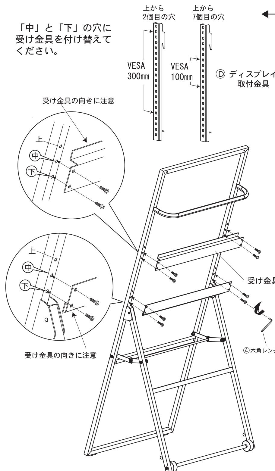
ご使用になるディスプレイに合わせたボルトでディスプレイ取付金具を取付けます。
