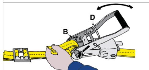
3. Surringen strammes ved at placere spændet 50 cm fra låsen på den del af båndet, som er rundt om emnet. Spændet fastklemmes ved at trykke palen A ned, lægge båndet i spændet og igen lukke palen. Båndets løse ende (B) trækkes derefter igennem spændets aksel (C).
