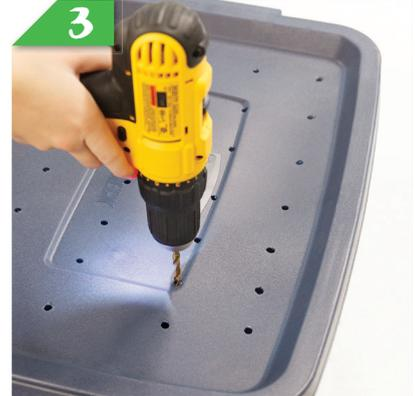
À l'aide de la perceuse et d'une plus petite mèche (les vers ne doivent pas être exposés à trop de luminosité), percer une trentaine de trous sur le dessus du bac.
