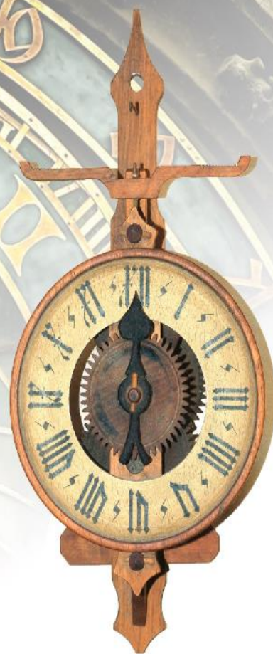
Un vecchio orologio con meccanismo di scappamento ad ancora.
