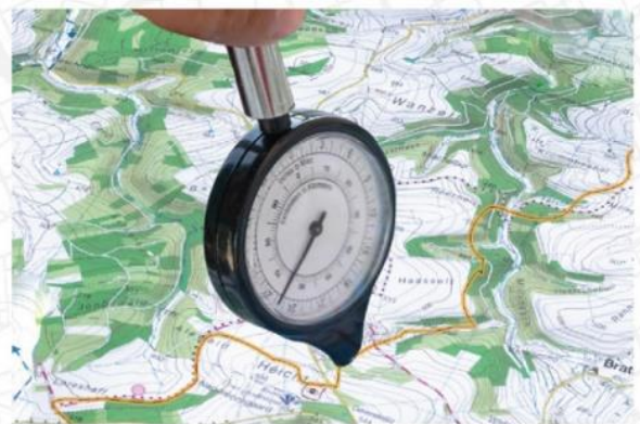
Fig 4. Linee di misurazione con un curvimetro.
