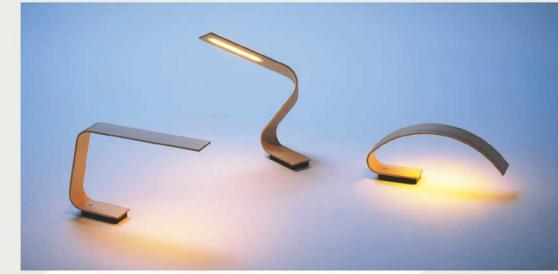
「TANZAKU Lamp」は使用シーンに合わせ、光源の高さと照明範囲を変えた3種類を用意。電池や制御部は金属パッケージ内に、照明部や配線は曲げ木の中に埋め込んでいる。なお、同製品にも使用されているリチウムイオン電池は木工製品に安易に使うと危険なため、「こうした製品を作りたいメーカーさんは当社に相談してほしい」と木村社長。
