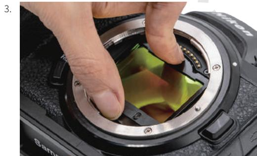
以拇指及食指分別輕壓上下濾鏡框並移除磁鐵，輕推鏡框使叩入快門簾前機腔內。
