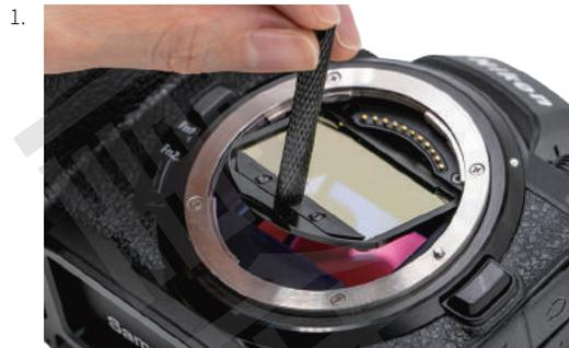
確實清潔濾鏡後，於乾淨無風的環境下移除鏡頭或機身蓋。濾鏡雷射刻字面朝向感光元件，使用小螺絲起子頂端磁鐵吸附起濾鏡下方墊片螺絲部位。
