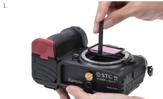
以螺絲起子頂端磁鐵吸附濾鏡墊片將濾鏡卸下。
