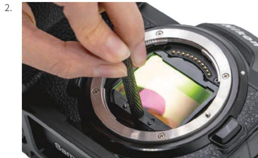
螺絲及墊片置於下側，將濾鏡上緣圓弧處對齊機身電子連接點下方艦體上緣，從上至下依序放入濾鏡。
