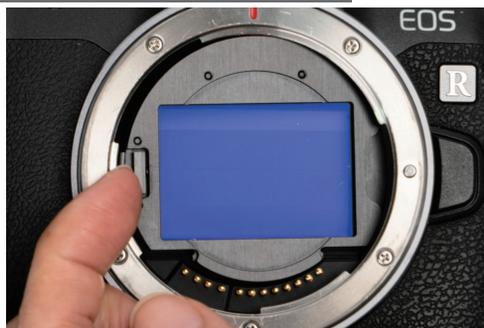
以指尖輕壓濾鏡左側按鈕將濾鏡勾起，並將機身卡口前傾倒(取)出濾鏡。
