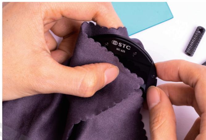
清潔鏡片並檢查鏡片是否穩固或者重新調整墊片位置，穩固即拆換完成。
