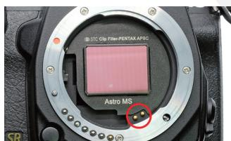
確認內置型濾鏡已經完全平放於感光元件前方並露出鏡頭電子連接點。
