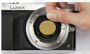
將內置型濾鏡傾斜約45度角由上方滑入貼近下方快門簾緣側・輕輕按壓濾鏡邊框上方金屬簧片使鏡片平貼快門簾。
