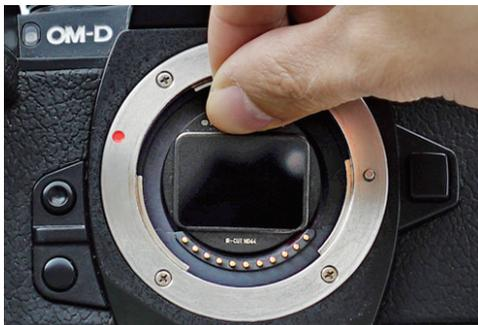
將内置型濾鏡傾斜約45度角由上方滑入貼近下方快門簾緣側，輕輕按壓濾鏡邊框上方金屬簧片使鏡片平貼快門簾。
