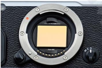
確認内置型濾鏡已經完全平放於感光元件前方・STC Logo在上方・鏡框上下簧片開口朝左。
