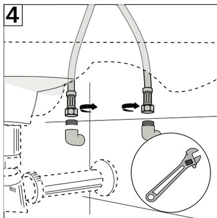
1-Conectar los flexibles a los terminales de la pared, primero con la llave indicada dar un 1/4 de vuelta, tomando con la mano libre el flexible para que no se enrosque.
