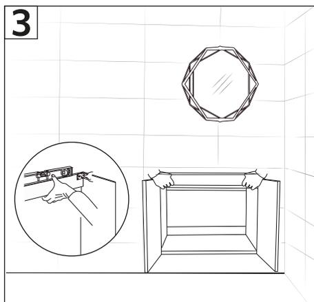
5-Colgar el mueble y verificar que este nivelado, al momento de fijar el mueble los pernos de fijación deben pasar a través de las escuadras ubicadas en las esquinas superiores internas.
