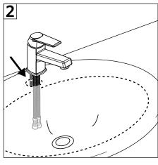
1-Posicionar la grifería en la perforación del lavatorio introduciendo los flexibles por
