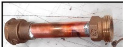
Soldar en un extremo del tubo el terminal HI y al otro extremo soldar roscada de la unión americana para gas.
