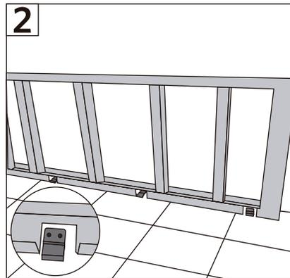
2- Instale las fijaciones del faldón con los tornillos que vienen incluidos.
