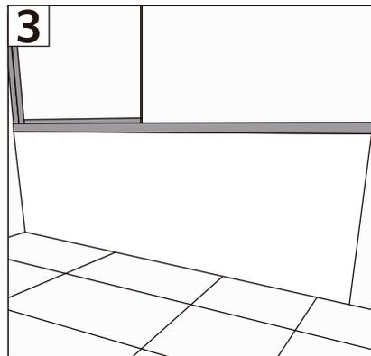
3- Una vez que la estructura de Metalcom este fija, instale el faldón a la estructura metálica.
