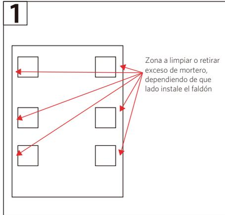
1-Posicionar la plantilla en el lugar de instalación del receptáculo, marque en el piso usando las perforaciones de la plantilla el lugar donde irán los apoyos y el desagüe.
