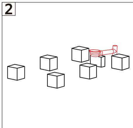
3-Fije el desagüe al ducto de descarga a una altura de 9cm desde la loza o piso.
