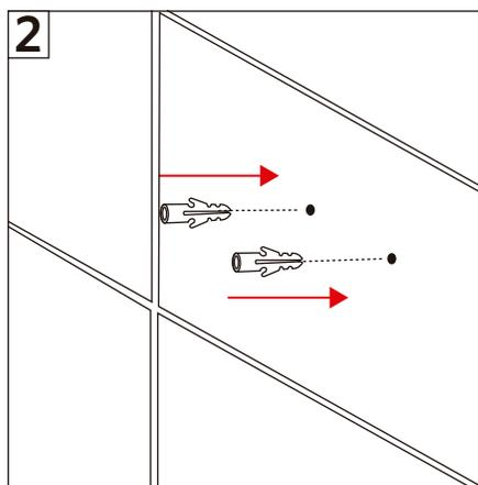
2- Perfore el muro con una broca de 25 mm.
