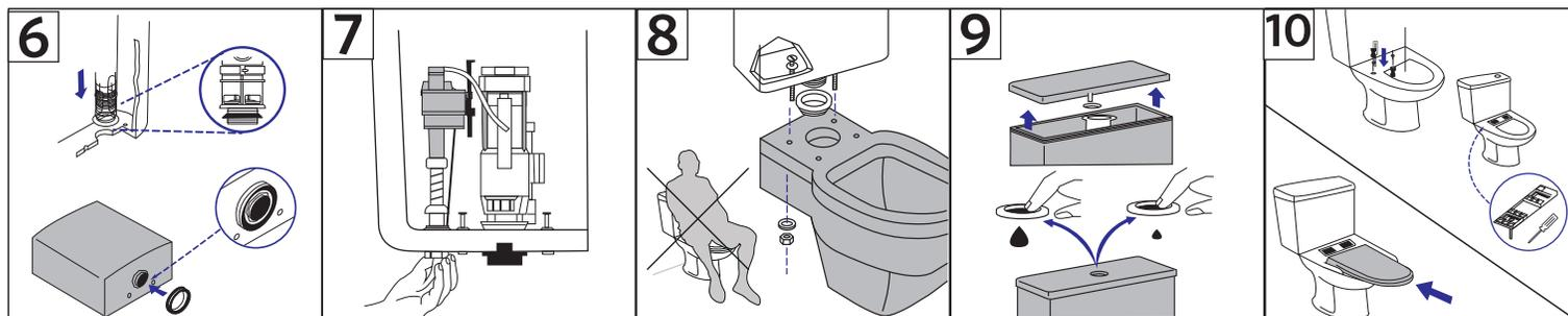
6. Cuando se instale el manguito de conexión excéntrico hay que picar el piso para que asiente bien el manguito excéntrico. Coloca la válvula de descarga en el estanque con su goma de ajuste, luego por debajo del estanque inserte la golilla y apriete con la tuerca al máximo con la mano (no apriete más de lo necesario), después inserte el collarín de goma sobre la tuerca.
