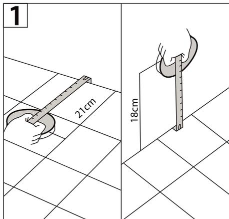
1-Para la instalación de inodoros con salida vertical verificar que el eje del tubo de desagüe de 110 mm ubicado en el piso, tenga una distancia de 21 cm desde su centro a la pared.
