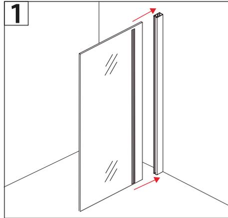
1-Utilizar silicona estructural para fijar la periferia al receptáculo y al muro.
