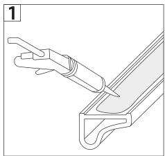
1-Utilizar silicona estructural para fijar la perfilería al receptáculo y al muro
