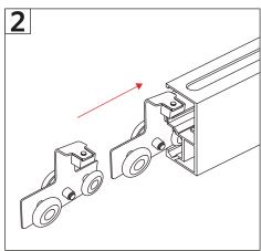
2-La mampara se desliza mediante 4 ruedas distribuidas en dos soportes, los cuales están ubicados en los extremos de la hoja de cristal
