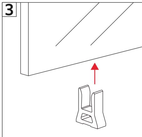
3-Incluye soportes para ayudar en la nivelación de la puerta en el proceso de instalación y que evita daños durante la misma.
