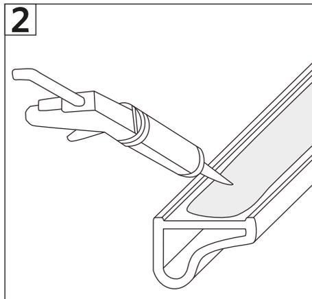
2-Utilizar silicona estructural para fijar la periferia al receptáculo y al muro.
