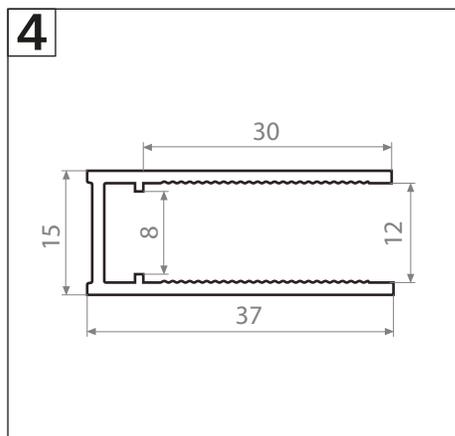
4-Perfil al muro que permite un ajuste de 27mm, este perfil se fija al muro mediante tornillos (5Un.) que se distribuyen en la altura.
