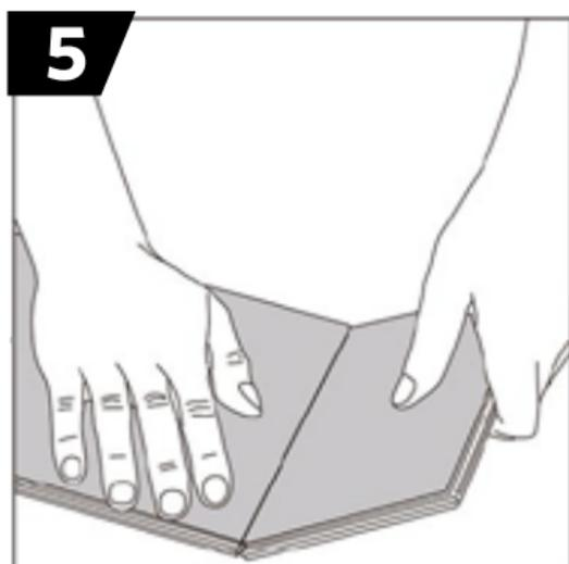
Luego levante la mitad de la duela usando su otra mano para sostener la placa firmemente lo mas cerca del lugar de corte, de este modo se dividirá fácilmente.
