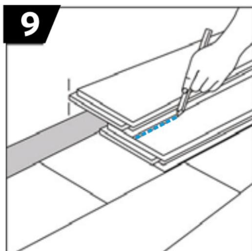
Para instalar la última fila, posicione una duela alineada sobre la penúltima fila y una segunda placa tocando el muro. Luego dibuje una línea en todo el largo de la pieza y córtela usando los pasos previos (el ancho debe ser de al menos 5 cm)
