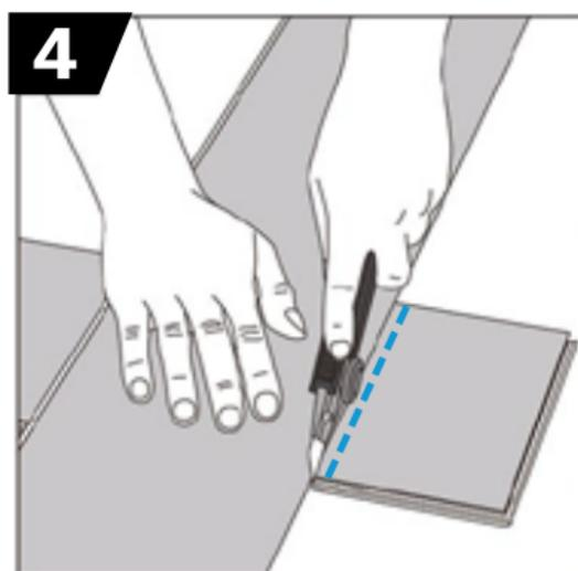
Para cortar la duela use corta cartón y regla. Utilice la cara superior de la placa y presione el filo firmemente repasando varias veces el mismo trazo.
