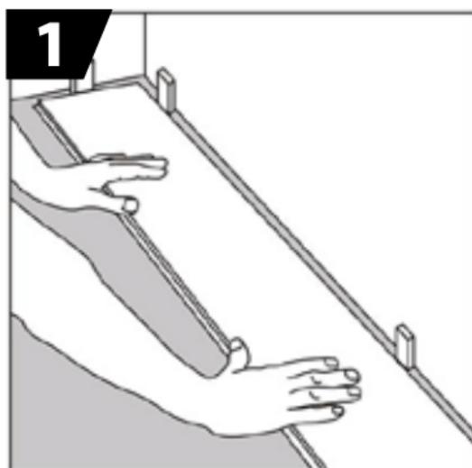
Después de limpiar cuidadosamente la superficie. Posicione la primera duela comenzando en la esquina de su mano izquierda utilizando cuñas de separación de 5 mm aprox.
