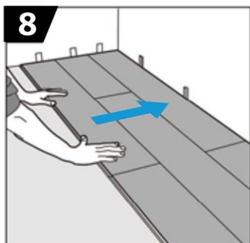
Después de finalizar la instalación de la fila, revise que todas las duelas estén bien instaladas sin espacios. Repita el proceso hasta completar toda el área.
