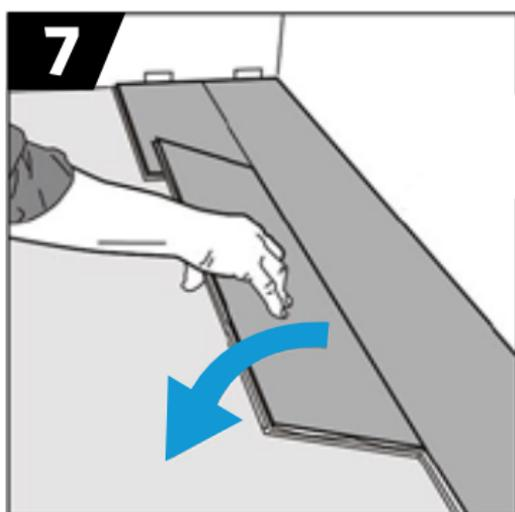
Asegure la duela completa a la fila anterior con un ángulo de 30 grados. Luego suelte la placa y presione hacia abajo fijando el sistema click 2G hasta que ambas duelas estén completamente niveladas.
