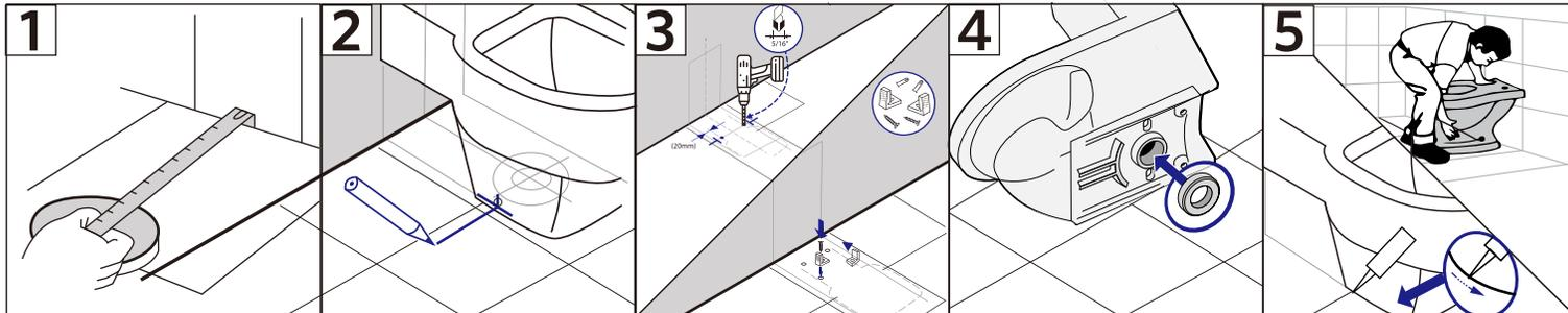
1. Verifique las medidas disponibles en su baño. La distancia mínima entre la pared y la línea central del tubo de descarga del sanitario debe ser de 305mm. Corrobore además las medidas de su producto con ayuda de un flexómetro.
