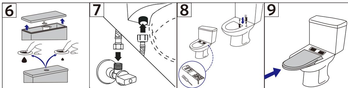
6. Fije la botonera en la tapa del estanque con su tuerca por dentro de la tapa, asegúrese de que los botones de descarga mayor y menor coincidan con los de la válvula de descarga. Regule el largo de los pernos de la botonera para que estos no queden presionando permanentemente la válvula de descarga, así evitará filtraciones de agua.
