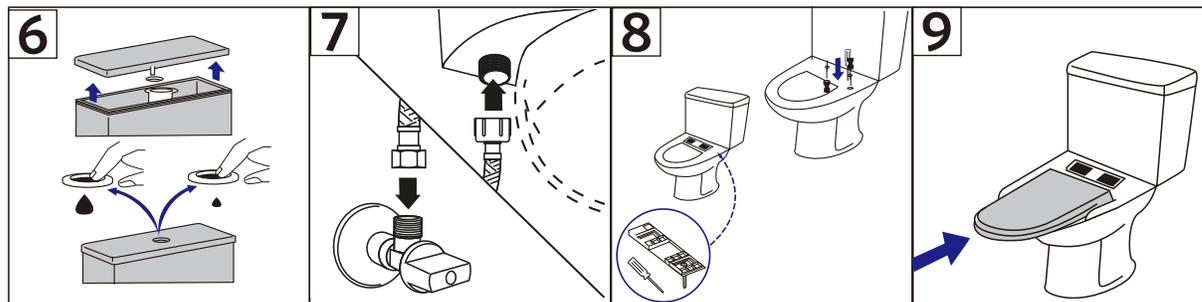
6. Fije la botonera en la tapa del estanque con su tuerca por dentro de la tapa, asegúrese de que los botones de descarga mayor y menor coincidan con los de la válvula de descarga. Regule el largo de los pernos de la botonera para que estos no queden presionando permanentemente la válvula de descarga, así evitará filtraciones de agua.
