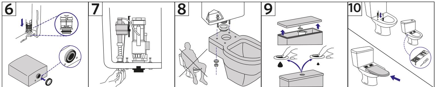
6. Cuando se instale el manguito de conexión excéntrico debe picar el piso para que asiente bien el manguito excéntrico. Coloca la válvula de descarga en el estanque con su goma de ajuste, luego por debajo del estanque inserte la golilla y apriete con la tuerca al máximo con la mano (no apriete más de lo necesario), después inserte el collarín de goma sobre la tuerca.
