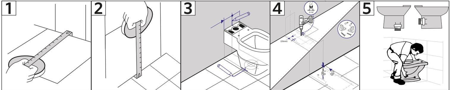
1. Para la instalación de inodoros con salida vertical verificar que el eje del tubo de desagüe de 110 mm ubicado en el piso, tenga una distancia de 21 o 30\* cm, dependiendo del tipo de manguito a utilizar, desde su centro a la pared.
