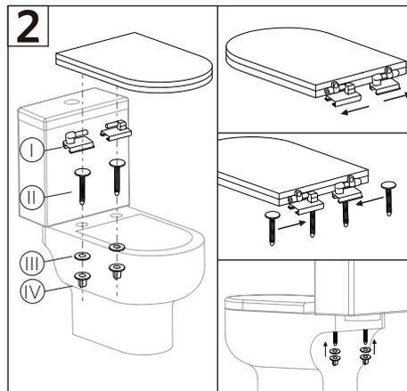
2- Para instalar la tapa del WC debe introducir los sujetadores de placa de cubierta (I) en la tapa.
