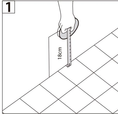
1- Para la instalación de inodoros con salida horizontal verificar que el eje del tubo de desagüe se encuentre a 18 cm desde el piso terminado.
