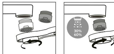
Si la grifería incluye un segundo aireador y cuenta con uno incorporado que permite reducir el consumo de agua en hasta un 60%, en caso de requerir un mayor flujo de agua, puede intercambiarlo por el segundo aireador, que ahorra en hasta un 30% de agua.
