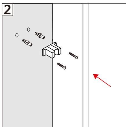
6- Marcar en la pared los puntos de instalación del soporte de la columna.
