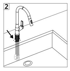
4- Posicionar la grifería en la perforación del lavatorio introduciendo los flexibles.
