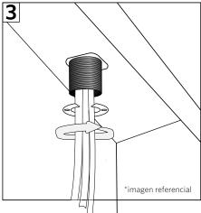
5- Por debajo del lavatorio posicionar el anillo de goma, arandela metálica y atornillar la tuerca de fijación.
