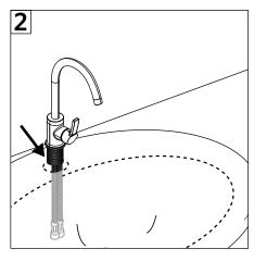
3-Posicionar la grifería en la perforación del lavatorio introduciendo los flexibles por
