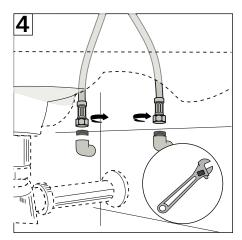
5- Conectar los flexibles a los terminales de la pared, primero con la mano, y después con la llave indicada dar un 1/4 de vuelta, tomando con la mano libre el flexible para que no se enrosque.
