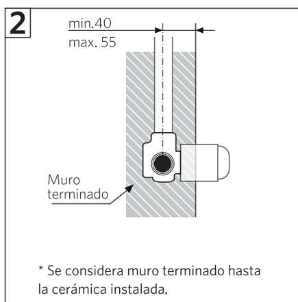
1-El cuerpo del producto deberá quedar empotrado a una profundidad de 40mm como mínimo y 55mm como máximo, desde el eje de las cañerías hasta el muro terminado.
