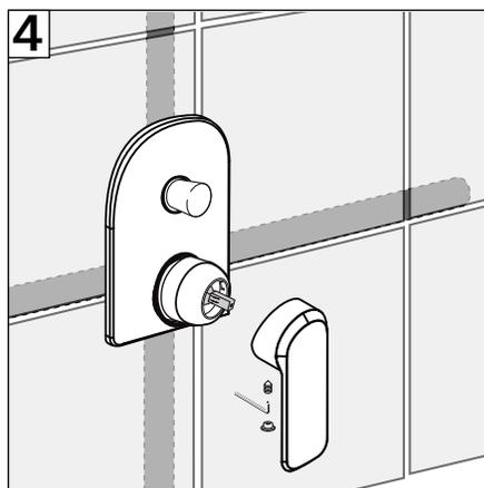
4-Insertar el embellecedor luego de sellar el muro con la cerámica. Luego instalar la manilla apoyado con una llave Allen para el prisionero y finalmente colocar la gomita.
