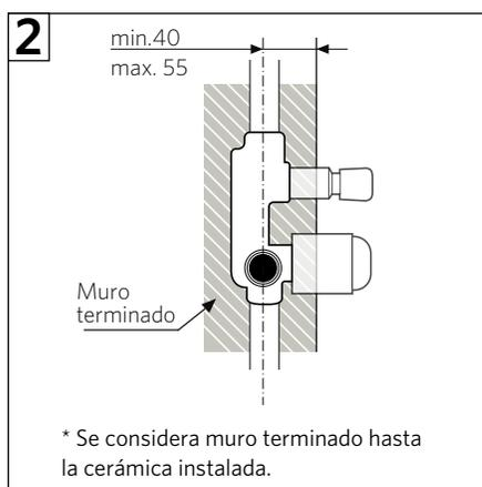
2-El cuerpo del producto deberá quedar empotrado a una profundidad de 40mm como mínimo y 55mm como máximo, desde el eje de las cañerías hasta el muro terminado.
