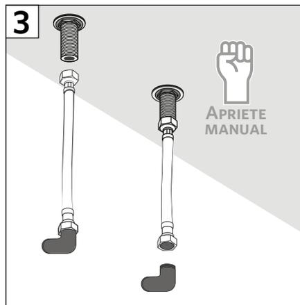
4- Ajustar firmemente los flexibles a los hilos de la grifería. Luego conectar los flexibles a los terminales de la pared, primero con la mano, y después con la llave indicada dar un 1/4 de vuelta, tomando con la mano libre el flexible para que no se enrosque.
