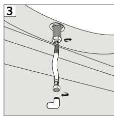
3- Conecte los extremos del flexible, uno a la grifería y el otro al terminal de agua fría o caliente, enroscándolos en forma manual.
