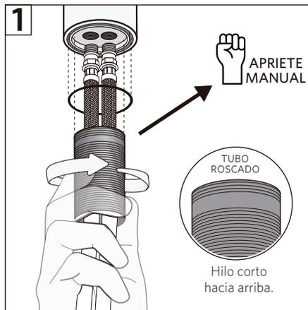
1- Introducir los flexibles a través del tubo roscado e insertar el O´ring en la base.
