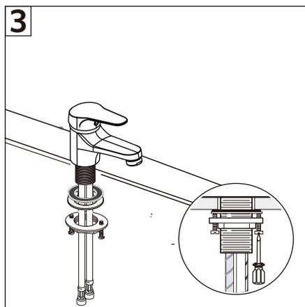
1- Por debajo, instalar el el sello de goma junto con el metálico y la tuerca de fijación.
