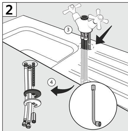
3- Ubicar la grifería en la perforación del lavaplatos, introducir los flexibles y espárragos.
