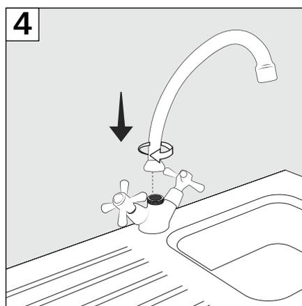
6- Si el caño está desmontado, ajuste firmemente la tuerca con la mano. Luego verifique que no existan filtraciones en la conexión abriendo el paso de agua.
