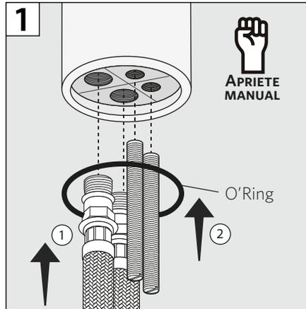
1-Conectar los flexibles y los espárragos en la parte inferior de la grifería, enroscar y dar apriete manual.
