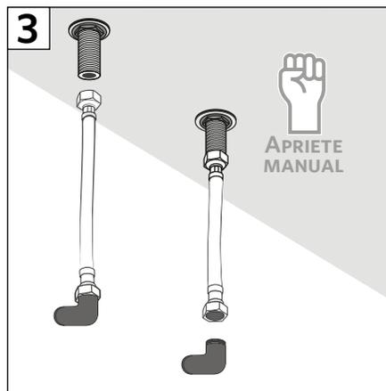
5- conectar los flexibles a los terminales de la pared, primero con la mano y luego con la llave indicada dar un 1/4 de giro, tomando con la mano libre el flexible para que no se enrosque.
