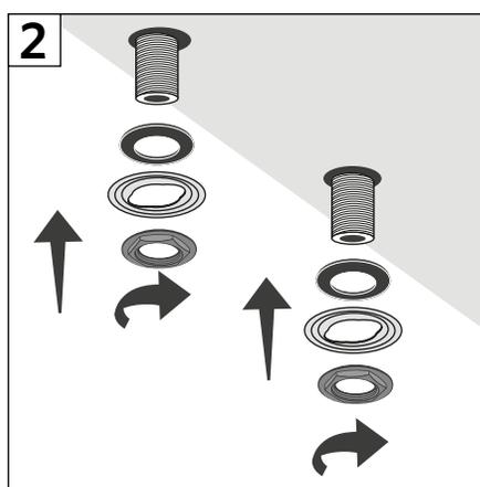
3- Por debajo del lavaplatos colocar la goma plana y la placa metálica en el hilo de la grifería. Ajustar ambos componentes con la contratuerca
