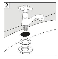
2- Posicione la grifería en la perforación central del lavamanos, introduciéndola en ella. Por debajo del lavamanos, coloque la placa corrugada a través del tubo de la grifería y asegúrela con la contratuerca.
