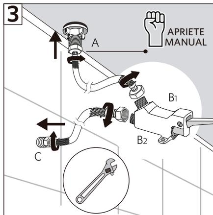
1. Ajuste firmemente el flexible más largo con conexión de 1/2" HI a la rosca de la tubería de la grifería (A) y ajuste el extremo sobrante al pedal en la rosca superior (B1). El flexible más corto con conexión de 1/2" HI unirá la rosca inferior del pedal (B2) y la toma de agua correspondiente (C). Considere siempre que los flexibles se mantengan sin torsiones para lograr el libre paso de agua.
