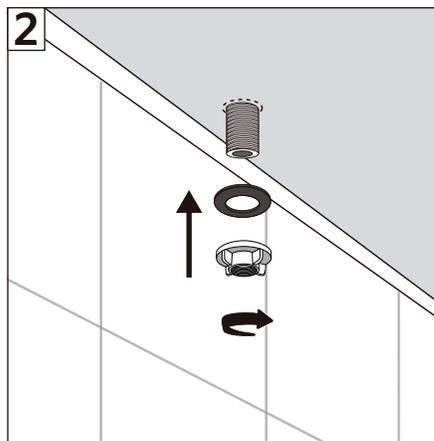
1- Por debajo del lavaplatos colocar la goma plana en el hilo de la grifería. Ajustar ambos componentes con la contratuerca.
