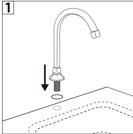
1- Colocar la campana y el O´Ring en el hilo de la grifería e introducir el cuerpo por las perforaciones del lavaplatos.
